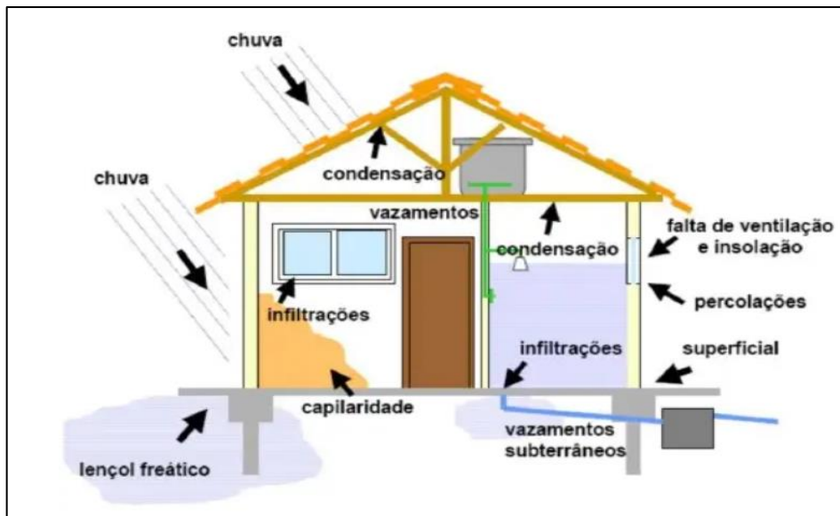
Figura 2 - Ação das águas em uma edificação
