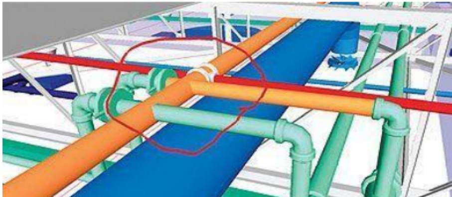
Figura 3 – Interferência de tubulações
